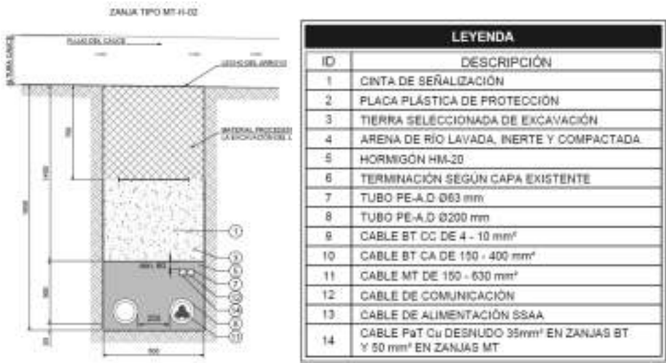
Figura D.15. Metodología de los cruces entre el zanjeado y los cursos de agua.
