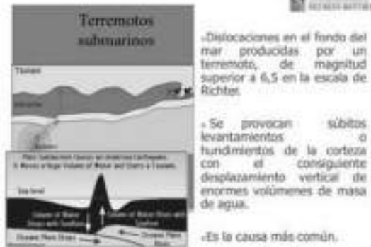
Figura. 1.-Esquema tsunami generado por un terremoto submarino y por subducción de una glacia submarina [Refer.2]
