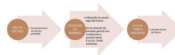
La red de aguas fecales recogerá en los puntos de acometida las aguas desechadas y las conducirá por gravedad hasta el punto bajo del Sector SUO-LI-01, "Los Lances". En dicho punto se recogerán las aguas fecales en una estación de bombeo ubicada dentro del Sector. Desde ahí serán impulsadas mediante una conducción a presión hasta la E.D.A.R. de Tarifa ubicada al Este del Sector.
