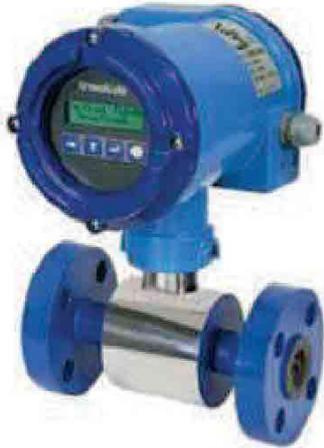
Son equipos de medición de caudal que se basan en la ley de Faraday, que establece que en un conductor eléctrico que se desplaza a través de un campo magnético, se induce una tensión que es directamente proporcional a la velocidad del conductor, y a la magnitud del campo electromagnético.
