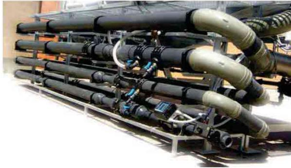
El equipo lleva instalado un sistema integrado de control de pH tras la administración de coagulante, para mantener el pH de trabajo óptimo de los floculantes. El control se realiza a través de una sonda de pH en línea y un control electrónico P.I.
