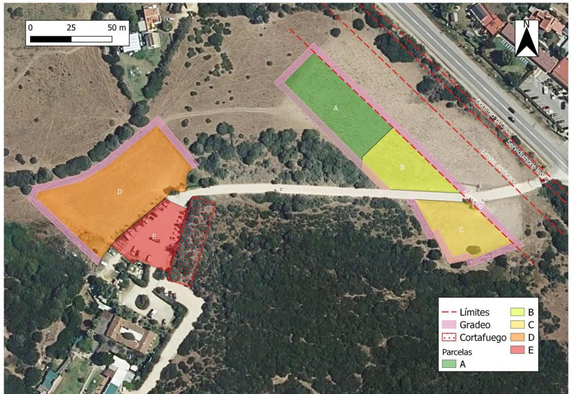
Figura 9. Plano con la disposición del gradeo perimetral y el cortafuego
