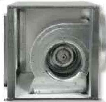
Cajas de ventilación, de bajo nivel sonoro, fabricadas en chapa de acero galvanizado, aislamiento acústico (MI) de espuma de melamina, ventilador centrífugo de doble aspiración montado sobre soportes antivibratorios, rodete de álabes hacia adelante equilibrado dinámicamente y motor monofásico o trifásico, Clase F (II), según versión. Todos los ventiladores montados en las cajas CVB/CVT CENTRIBOX cumplen con los requisitos de eficiencia de la Directiva ErP.
