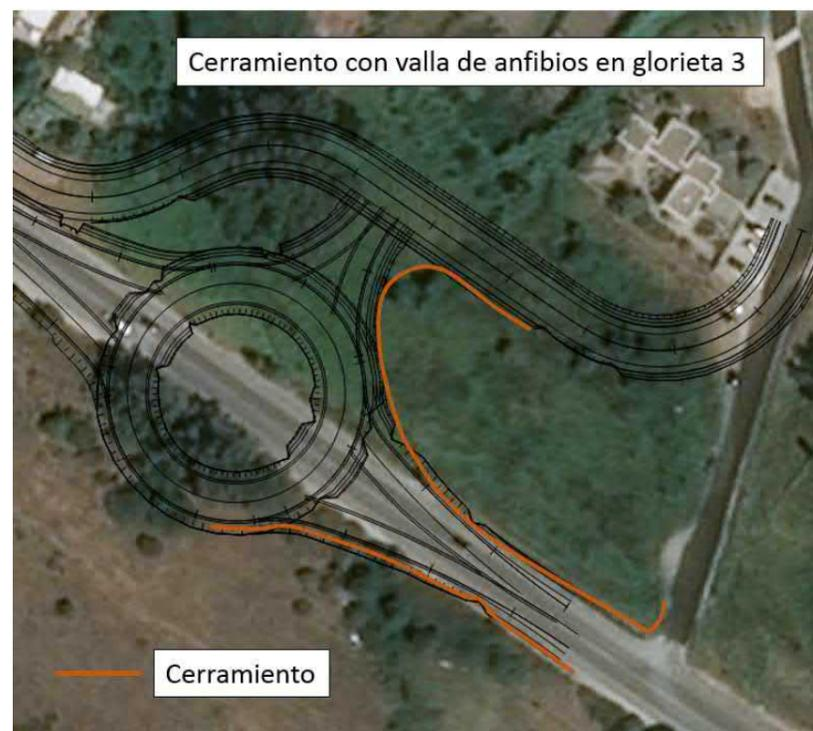
Figura 24. Disposición del cerramiento con valla de anfibios en la Glorieta 3
