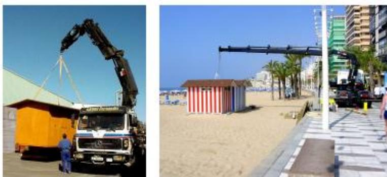
Carga y descarga de los módulos. Cintas de 5 m. de longitud
