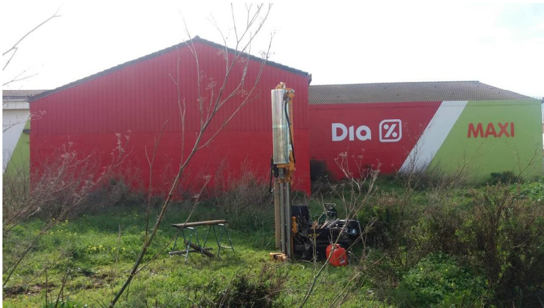
Emplazamiento de la sonda testiguera a rotación en el punto reseñado como SR-4.
