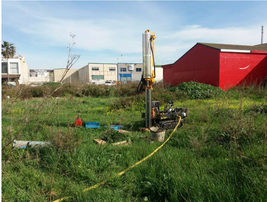
Emplazamiento de la sonda testiguera a rotación en el punto reseñado como SR-3 (Sondeo corto)
