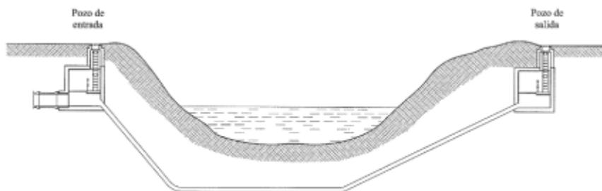
Fig 50. Esquema de sifón
