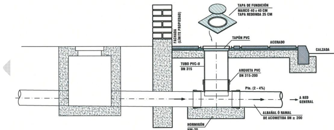
En las edificaciones con sótano, con objeto de que la propiedad pueda realizar el mantenimiento de la instalación interior, se instalará como elemento de registro, en línea con la acometida una pieza en "Y" a 45° con tapón de registro para permitir su limpieza. Para su ubicación se aplicarán los mismos criterios que en el caso de la arqueta, es decir, zona común.
