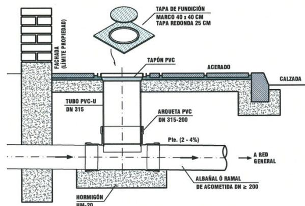
El tubo vertical hasta el nivel del acerado será de PVC-U de pared compacta DN 315 mm con tapón de PVC incorporado para evitar la salida de gases y olores. Y en la parte superior se rematará, a nivel de acerado, con un registro de marco cuadrado de 40 x 40 cm y tapa redonda de 25 cm de diámetro.
