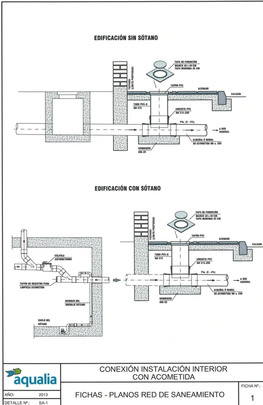
AIV.2. ACOMETIDA CON ENTRONQUE A POZO PREFABRICADO DE HORMIGÓN
