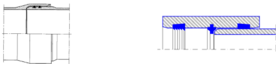
Unión enchufe campana con anillo elastomérico
